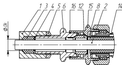
з) монтаж бронированным кабелем в металлокукарке в кабельном вводе КВБМ
