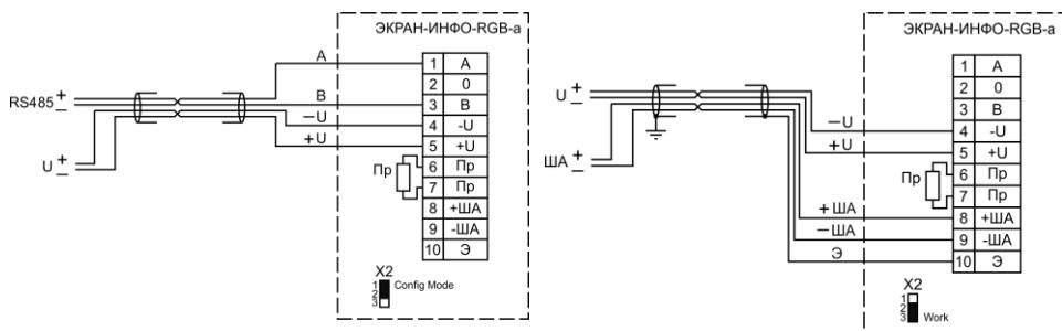
**U** – внешний развязанный источник питания  $U_{\text{H}}=24 \text{ В} \pm 10\%$ ; **RS485** – преобразователь интерфейсов USB-RS485 для подключения оповещателя к компьютеру; **ША** – адресная линия связи ППКиУП “Vesta 01F” или модуля сопряжения “MC-5”.
