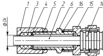
г) монтаж кабелем в металлокукарке в кабельном вводе КВМ
